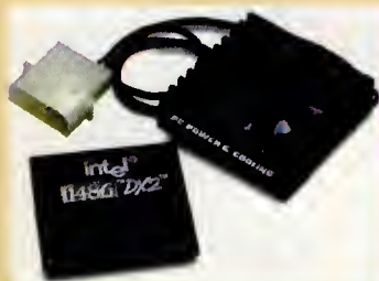
Disipadores de color para aumentar el rendimiento de los microprocesadores. El calor es uno de los principales enemigos de los componentes electrónicos.
